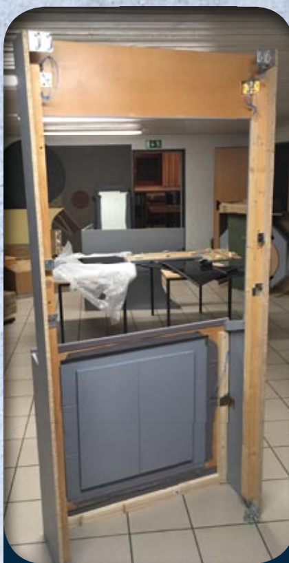
Hier sieht man das Steckkonzept der Kulissen: Alle Teile werden schraubfrei mit Steckscharnieren zusammengebaut.
